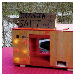
Fantastic drinks, Robotik Oliver Müller (13) Selbstgebaute Getränkeautomat, der je nach Einsatzzweck mit oder ohne Bezahlung funktioniert.
